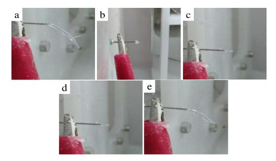
*Fig. 1. The shape of taylor cone with flow rate (a) 0.01 μl / h, (b) 0.05 μl / h, (c) 0.1 μl / h, (d) 0.15 μl / h, (E) 0.20 μl / h.*
