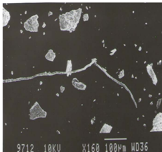
Fig. 3 SEM of ZnO:Mn nanobelt
