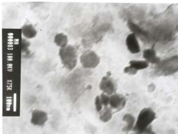
Fig. 2 TEM of ZnO:Mn nanoparticles
