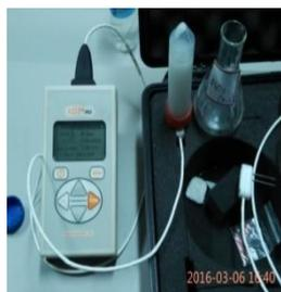
Fig.2. KD2-Pro thermal analyzer
