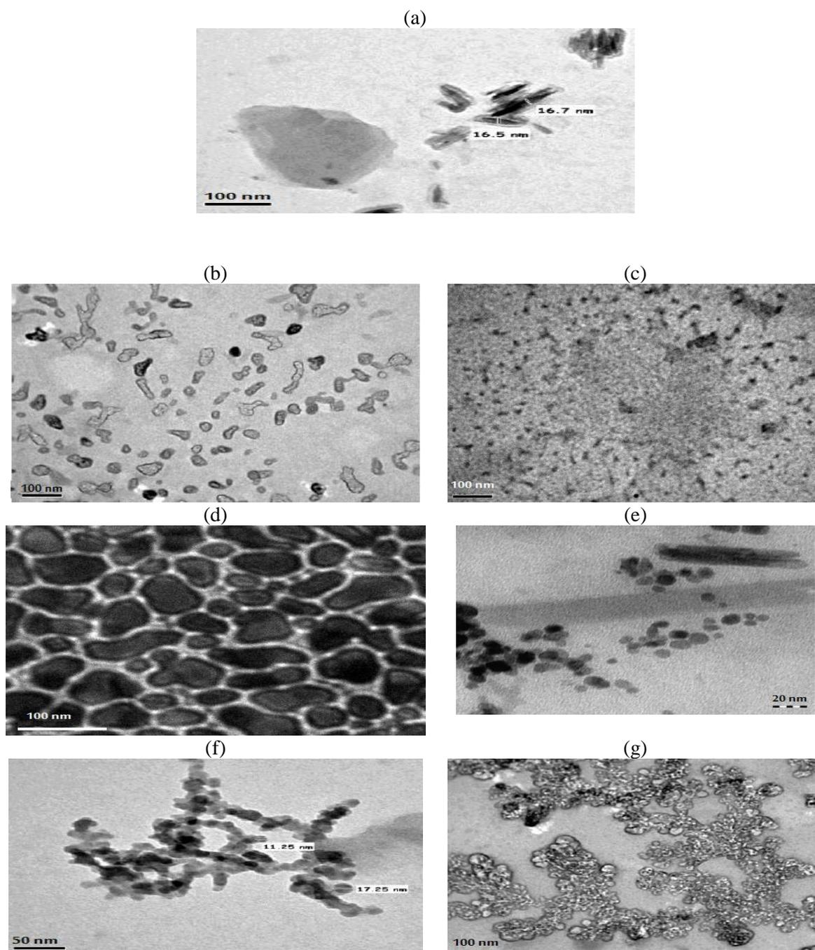
Fig.3. TEM photos of a) Na-MMT, b) Na-MMT/PAMPS, c) Na-MMT/PAMPS-Na, d) Na-MMT/NIPAm, e) Na-MMT/PAAm, f) Na-MMT/PAA and g) Na-MMT/PVP nanogels.
