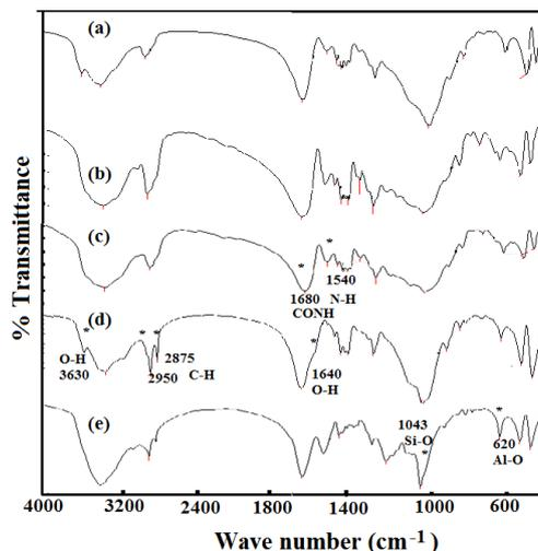
Fig.1. FTIR spectra of Na-MMT nanogels polymers a) PNIPAm, b)PVP, c)PAAm, d)PAMPS and e)PAMPS-Na
